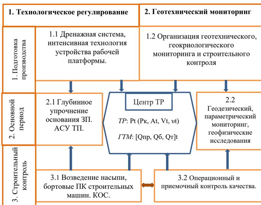
Рис. 1. Структура технологического регулирования и мониторинга строительства геотехнических объектов [разработано авторами].
