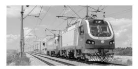
Односекционный магистральный пассажирский электровоз КZ4АТ был разработан Alstom и Трансмашхолдингом (ТМХ) специально для нужд рынка СНГ и сложных климатических условий региона. Он способен развивать скорость до 200 км/ч и эксплуатироваться при температурах от -50 °C до +45 °C. В конструкции использована современная тяговая система Alstom, а также комплектующие, производимые компанией и ТМХ.
