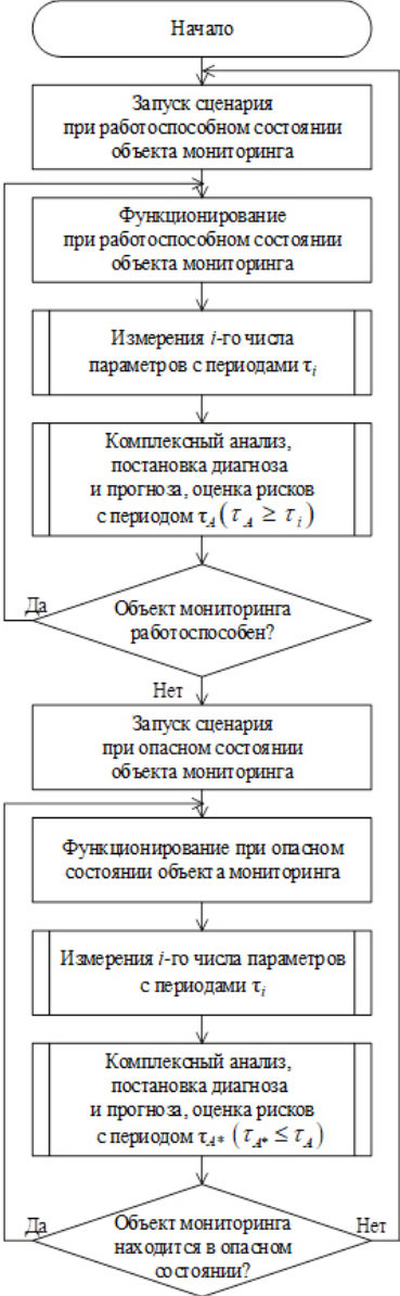
Рис. 4. Алгоритм информационного сопряжения СММК и ИТС [разработано авторами].
