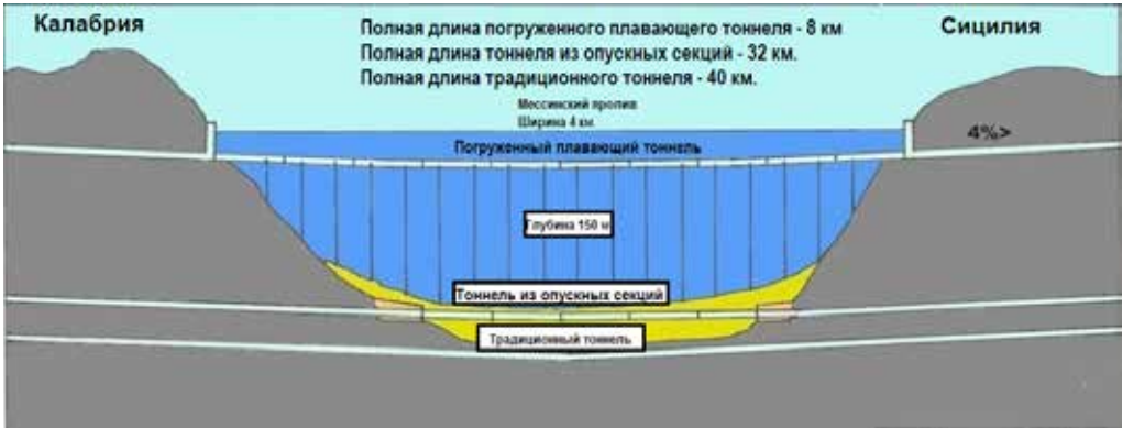
Рис. 3. Сравнение плавающего тоннеля с другими сооружениями [1].
