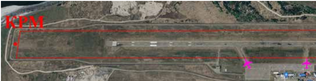
Рис. 8. Размещение ВС с размерами, соответствующими Boeing-737, вблизи границы критической зоны КРМ.
