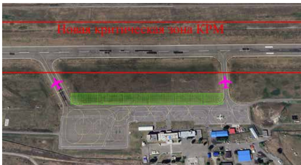
Рис. 10. Вариант расширенного перрона аэродрома Горно-Алтайск (указаны новая критическая зона КРМ и места размещения исследуемых объектов).
