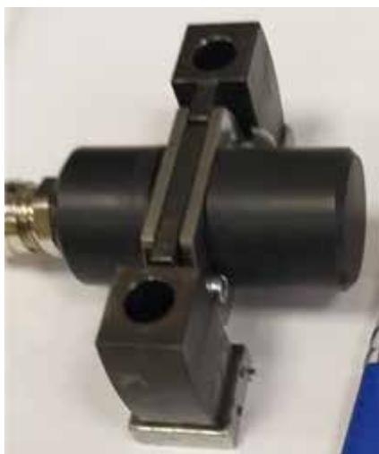
Рис. 2. Внешний вид оптико-поляризационного датчика [фото сделано авторами].
