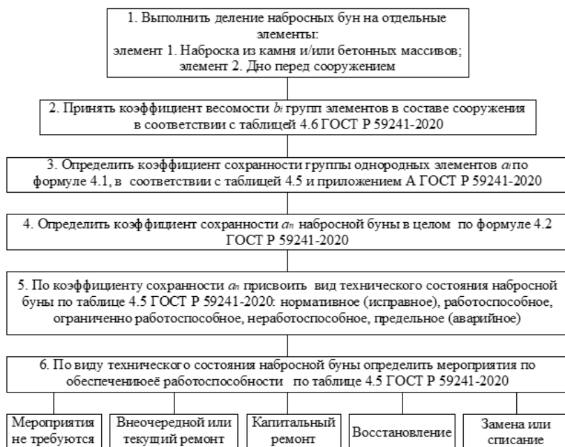
Рис. 7. Блок-схема для определения технического состояния и требуемых мероприятий по обеспечению работоспособности набросных бун [выполнено автором].
