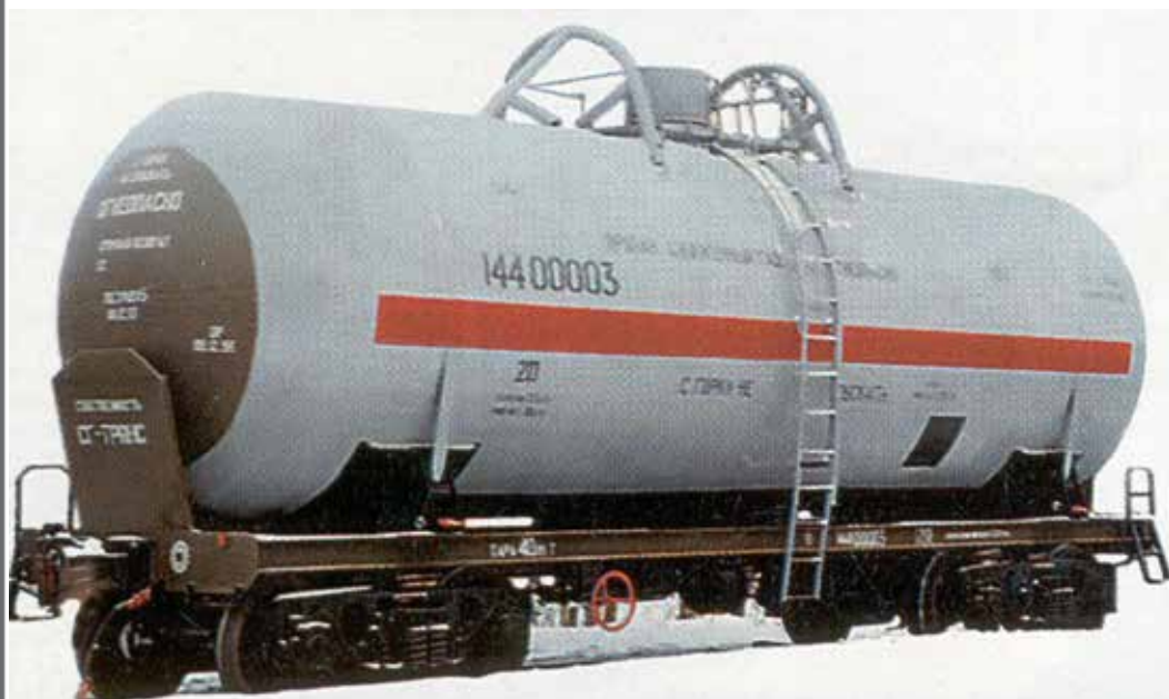
Рис. 1. Серийная цистерна для сжиженных углеводородных газов с техническими средствами защиты котла при аварийных режимах [фото кафедры вагонов и вагонного хозяйства РУТ (МИИТ)].
