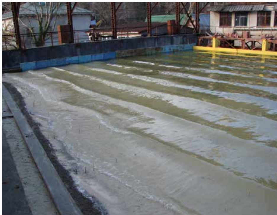
Рис. 2. Лабораторные исследования конструкций для защиты линейных сооружений (земляного полотна железных дорог) в волновом бассейне [выполнено автором].
