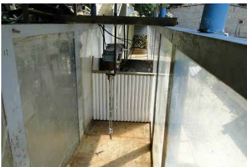
Рис. 5. Лабораторные исследования откосного волногасящего сооружения из камня в волновом бассейне [выполнено автором].
