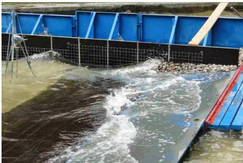
Рис. 5. Лабораторные исследования откосного волногасящего сооружения из камня в волновом бассейне [выполнено автором].
