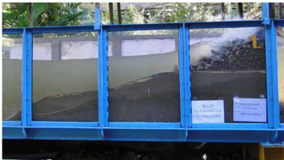
Рис. 3. Лабораторные исследования откосного волногасящего сооружения из фасонных массивов (тетраподов) при фронтальном подходе волн в волновом лотке [выполнено автором].
