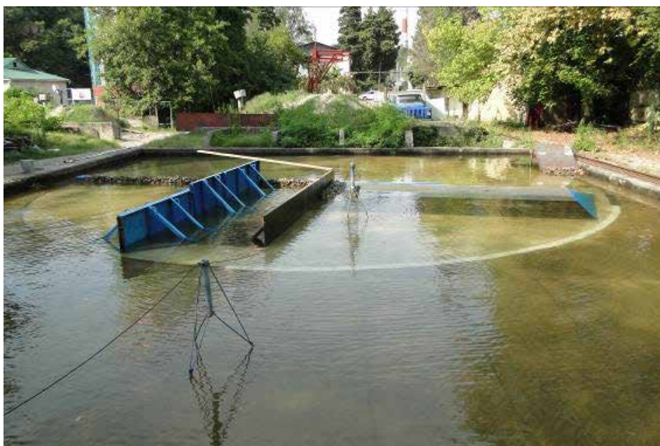
Рис. 4. Волновой бассейн с поворотным кругом для лабораторных исследований при различных углах подхода волн к сооружениям [выполнено автором].
