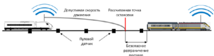
Рис. 3. Разграничение поездов в системе ATACS [выполнено авторами].
