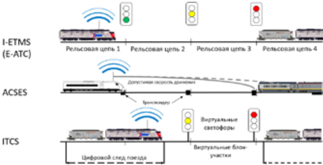
Рис. 4. Разграничение поездов в системах РТС [выполнено авторами].
