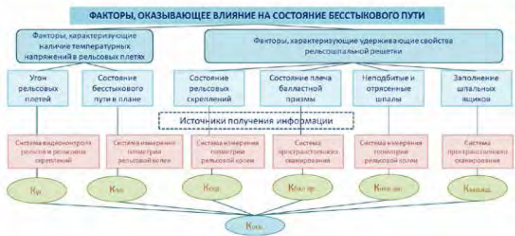
Рис. 1. Алгоритм определения комплексного коэффициента предотказного состояния бесстыкового пути [разработано автором].
