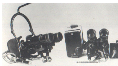
Рис. 4. Приборы ночного видения ОКБ-1, выпущенные Опытным электромеханическим заводом ВЭИ. 1942-1945 гг.
