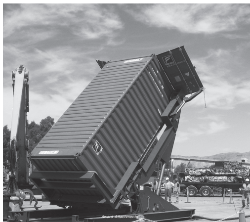
Рис. 2. Мобильный портовый кантователь с ломаной рамой.
