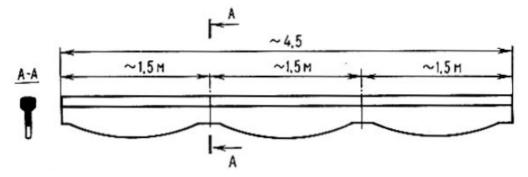
Puc. 3. Вид в профиль и разрез (A-A) «волнистых» рельсов. Верхнее строение. [Электронный ресурс]: http://railway-transport.ru/books/item/f00/s00/z0000020/st017.html. Доступ 11.06.2021.
