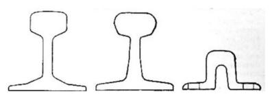
Рис. 6. Широкоподошвенный рельс, применявшийся на железных дорогах, соответственно, Нового Южного Уэльса, Большой Мидлендской железной дороге, Большой Западной железной дороге. [Электронный ресурс]: https://www.1902encyclopedia.com/R/RAl/railway-27.html. Доступ 11.06.2021.
