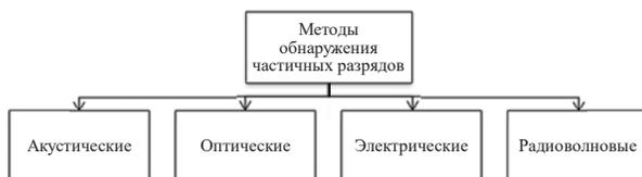
Рис. 2. Методы контроля частичных разрядов и их обнаружения [составлено автором].
