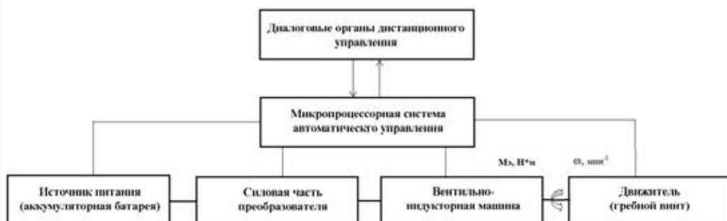
Рис. 1. Блок-схема системы управления движением ОПА [выполнено авторами].
