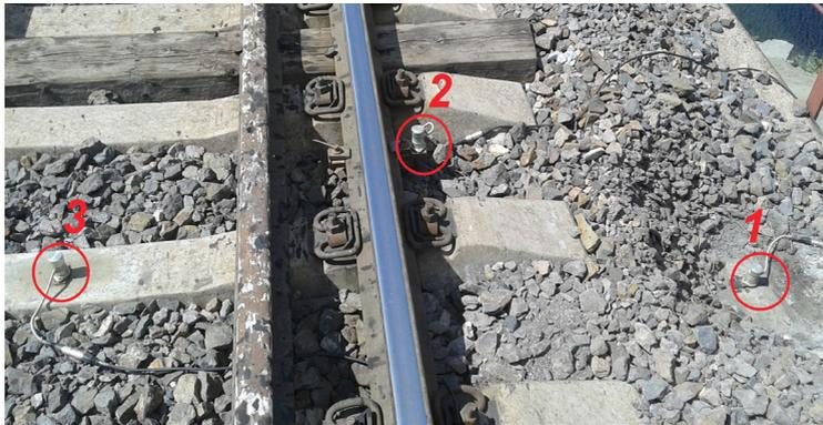
Рис. 4. Общий вид железобетонного пролетного строения с расположением вибродатчиков на элементах: 1 – середина балочного пролетного строения; 2 – подошва рельса; 3 – середина шпалы.
