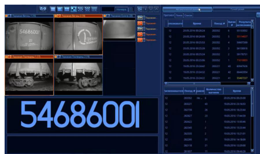
Рис. 5. Пример работы системы за контролем перемещения подвижного состава (выполнено авторами).
