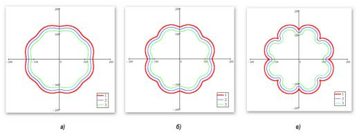
Рис. 3. Результаты моделирования профиля зубчатого колеса в системе автоматизации математических расчётов (выполнено авторами).
