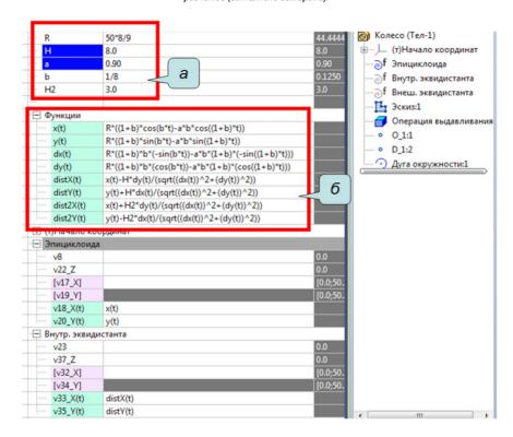
Рис. 4. Система управляющих переменных 3D-модели циклоидального зубчатого колеса (выполнено авторами).
