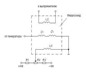
Рис. 3. Схема включения обмоток феррозонда (выполнена авторами).
