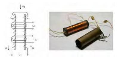
Рис. 1. Устройство феррозонда: H – поле возбуждения феррозонда, H<sub>n</sub> – измеряемое магнитное поле (выполнено авторами).
