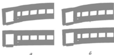
Рис. 4. Формы колебаний кузова на верхней (сверху) и нижней (снизу) ЧСИК при частоте колебаний оборудования 6 (а) и 9 (б) Гц (выполнено автором).
