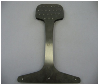
Рис. 2. Темплет рельса с вмятинами от шарика по методу Бринелля для определения твёрдости по поперечному сечению рельса [19].
