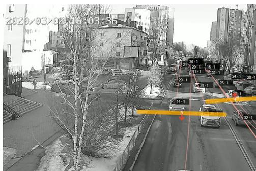
Рис. 6. Детекция номеров (слева) и анализ потока автомобилей по видеозображению (справа). (Данные номерного знака в публикации заретушированы).
