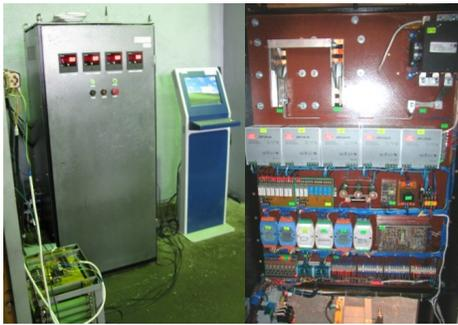
**Рис. 1. Автоматизированный стенд проверки выпрямительно-инверторных преобразователей электровозов переменного тока.**
