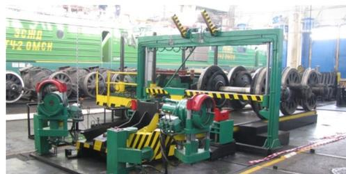
**Рис. 4. Технологическая позиция разборки колесно-моторных блоков локомотивов.**
