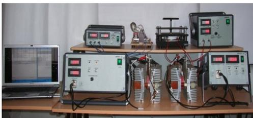
**Рис. 3. Комплекс для автоматизированных испытаний силовых полупроводниковых приборов.**
