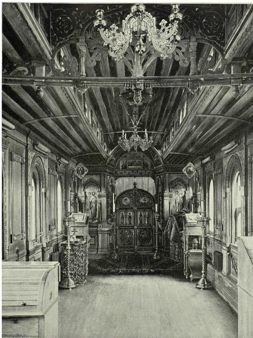
В 1912–1913 годах эти вагоны были оборудованы автономным электрическим освещением, которое раньше применялось только в служебных вагонах. В конструкциях пассажирских вагонов, построенных в дореволюционный период, массово использовалась древесина, а кузова обшивались снаружи листовым железом.
