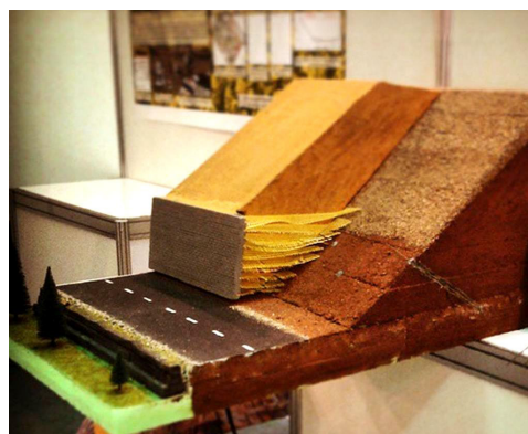
Рис. 6. Конструкция в трех измерениях: а) поперечный разрез насыпи; б) математическая объёмная модель; в) общий вид макета.
