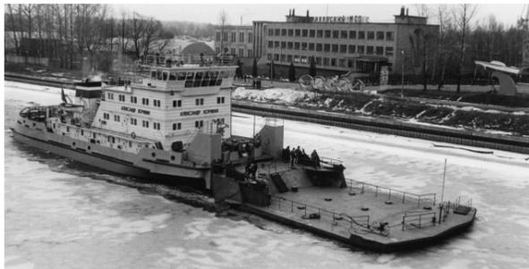
**Рис. 3. Опытный образец ледокольной приставки на воздушной подушке.**
