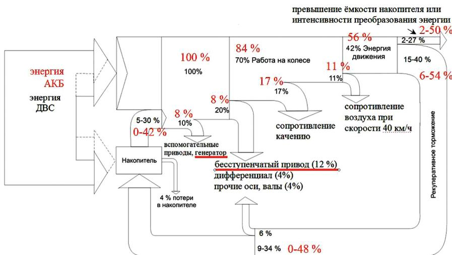
Рис. 3. Энергобаланс автомобиля с ДВС и электромобиля с рекуперацией энергии движения: подчёркнуты агрегаты, которые отсутствуют у электромобиля.
