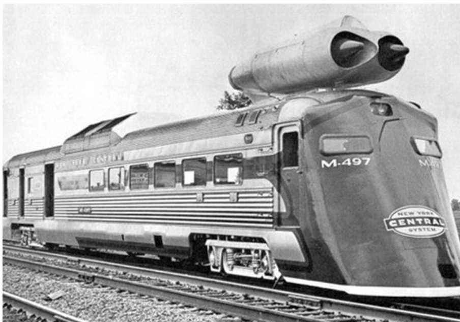
Experimental M-497 turbojet train («Black Beetle», 1966), USA.
