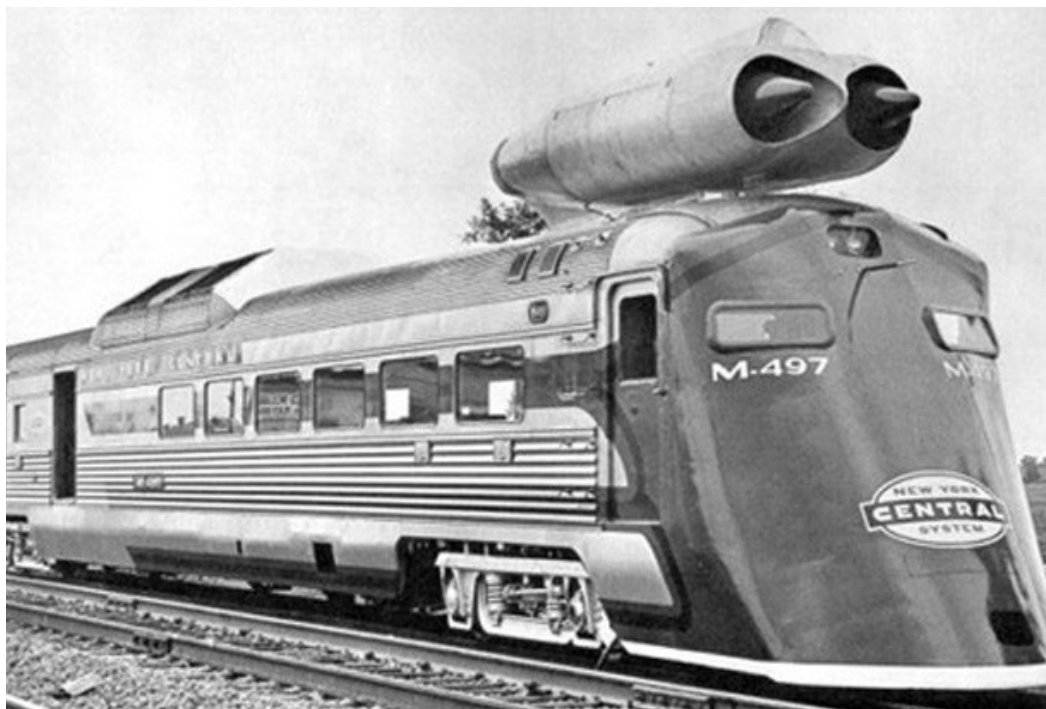
Экспериментальный вагон-лаборатория на реактивной тяге М-497 (США).
