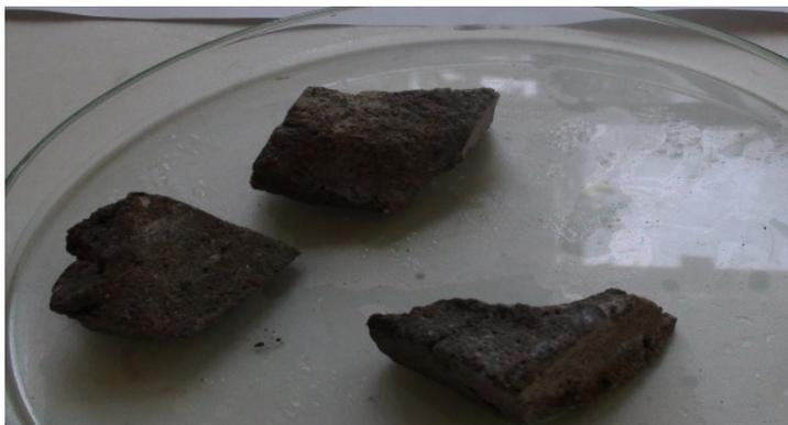
**Рис. 3.** Образцы бетона после 20 циклов исследования, выдержанные в трёхкомпонентной модели.
