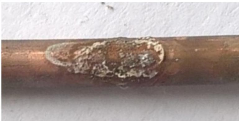
**Рис. 8б.** Фрагмент повреждения образца медного провода.
