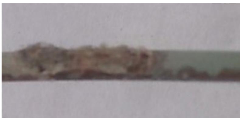
Рис. 9 г. Фрагмент III повреждения образца медного провода.
