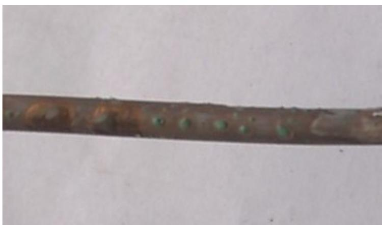
**Рис. 9б.** Фрагмент I повреждения образца медного провода.
