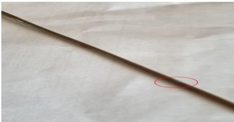
**Рис. 7а.** Вид образца медного провода, обработанного четырёхпроцентным раствором хлоридного ПГР при 200°С в лабораторной печи.
