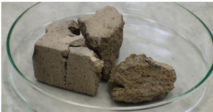
**Рис. 2.** Образцы бетона после пяти циклов исследования, выдержанные в трёхкомпонентной модели противогололёдного реагента.
