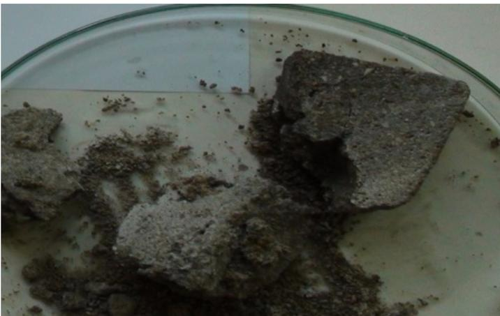
**Рис. 4.** Образцы бетона после 25 циклов исследования, выдержанные в трёхкомпонентной модели.
