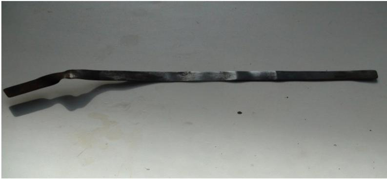
**Рис. 5.** Испытуемая железная пластинка после погружения в трёхкомпонентный раствор хлоридного ПГР.
