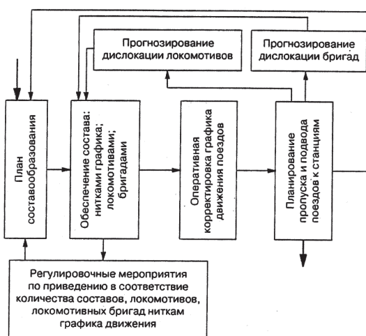
Рис. 3. Блок-схема технологического процесса планирования и управления поездной работой.
