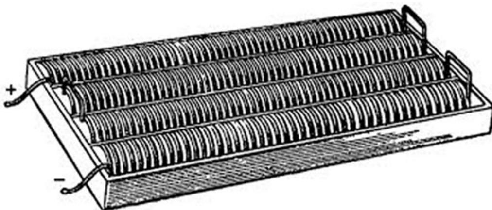
*Гальваническая батарея конструкции Петрова. Ящик был сделан из красного дерева и длина его составляла около трёх метров.*
