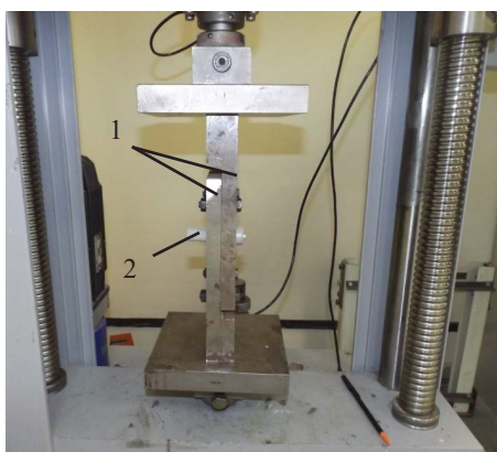
Рис. 2. Схема испытаний на одинарный срез: 1 – ножи; 2 – образец.
