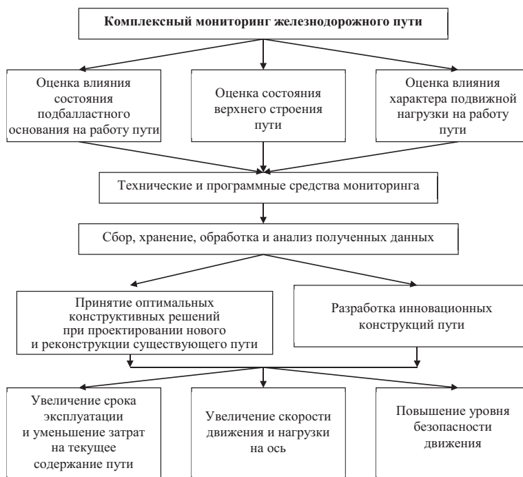
Рис. 2. Структурная схема комплексного мониторинга железнодорожного пути.
