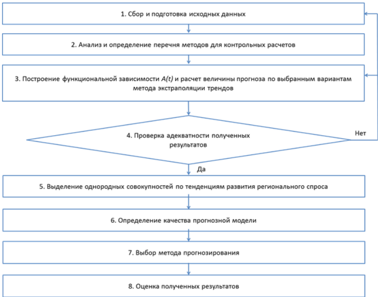
Рис. 4. Укрупнённая блок-схема процесса выбора метода экстраполяции трендов для прогнозирования объёмов внутрирегиональных пассажиропотоков.
