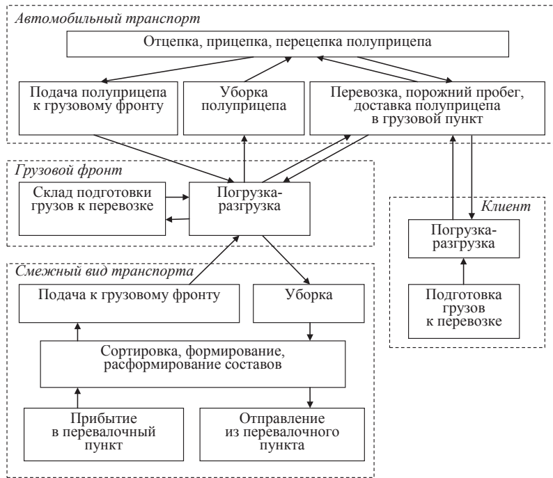
Рис. 2. Схема функционирования автомобильного транспорта при обслуживании получателей и отправителей контейнеров.
