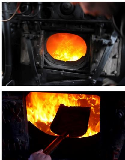
**Рис. 3. Топка паровоза в открытом и раскрывающемся состоянии.**
