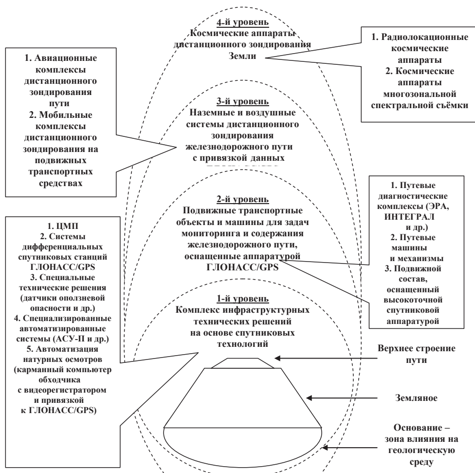
Рис. 5. Модернизированная система мониторинга пути и предупреждения ЧС.
