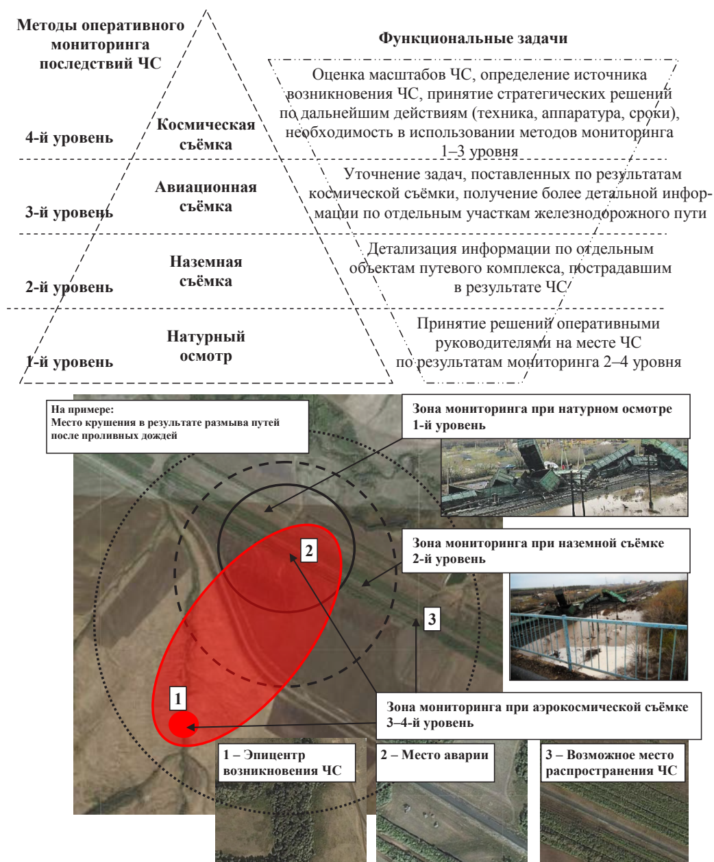
Рис. 6. Иерархическая структура решаемых задач и перспективной технологии мониторинга ЧС.
