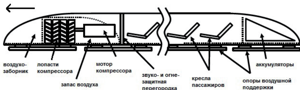
Рис. 3. Схематическое устройство пассажирского челнока Hyperloop.
