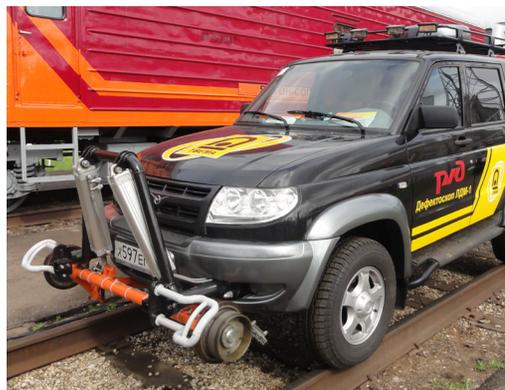
Рис. 2. Дефектоскопная лаборатория ЛДМ-1.
