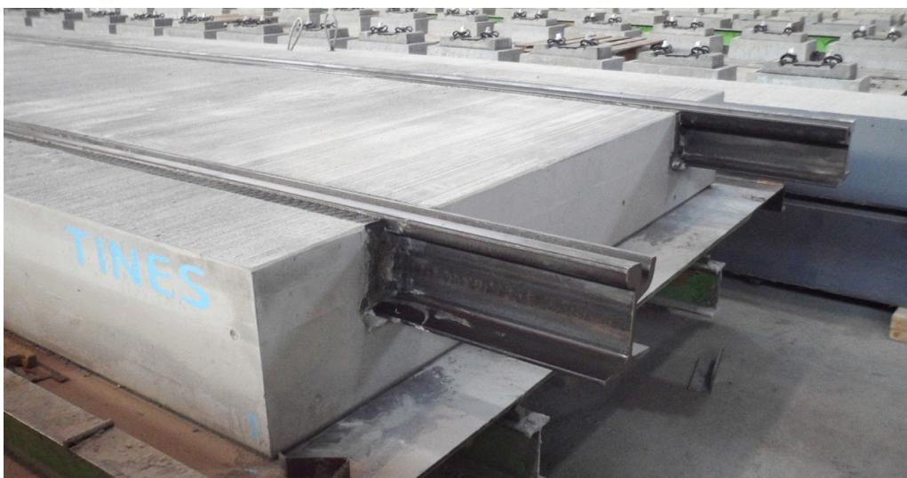
Рис. 3. Плита заводского изготовления TINES LC-L XL.
