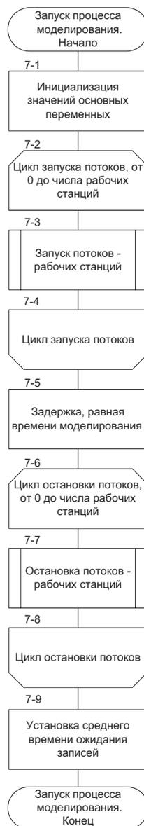
Рис. 2. Блок-схема модуля моделирования сетевой БД.
