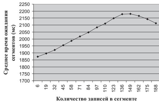
Рис. 7. График зависимости производительности СУБД от количества записей в сегменте.
