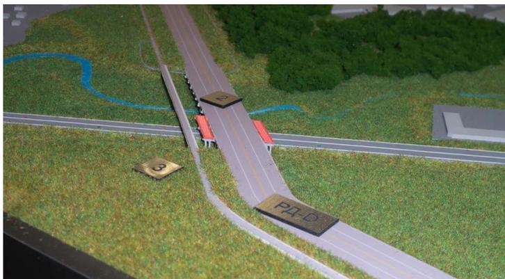
**Рис. 1. Проектное решение по устройству пересечения рулежной дорожки, патрульной аэродромной автомобильной дороги, трассы подъездной автомобильной дороги и реки Клязьма: 2 – рулежная дорожка РД-Д (22,5 м – искусственное покрытие и 18 м – покрытие обочин); 3 – патрульная аэродромная автомобильная дорога.**
