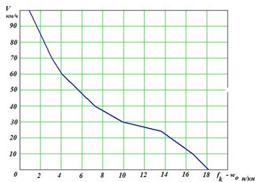
Рис. 2а. Удельная ускоряющая сила (в режиме тяги) 2ТЭ116УМ-23АГАЛ.
