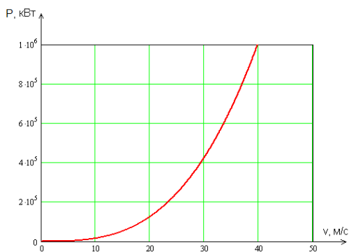
Рис. 7. Зависимость потребляемой мощности от скорости движения для судна каплевидной формы с традиционным двигателем (винтом) водоизмещением 4000 т.
