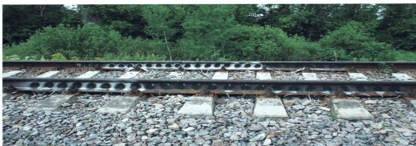
Рис. 2. Общий вид пути, оборудованного измерительными приборами для регистрации вертикальных сил.
