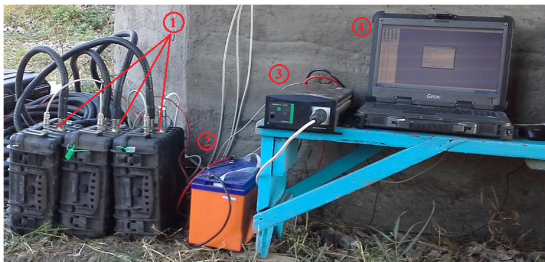
Рис. 3. Общий вид мобильного комплекса для тензометрических измерений: 1 – измерительные модули; 2 – аккумуляторная батарея; 3 – синусный инвертор; 4 – полупромышленный компьютер.
