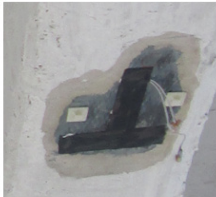
Рис. 2. Тензорезисторы FLM-60–11 с защитным покрытием от климатических воздействий на нижних гранях ребер плит.
