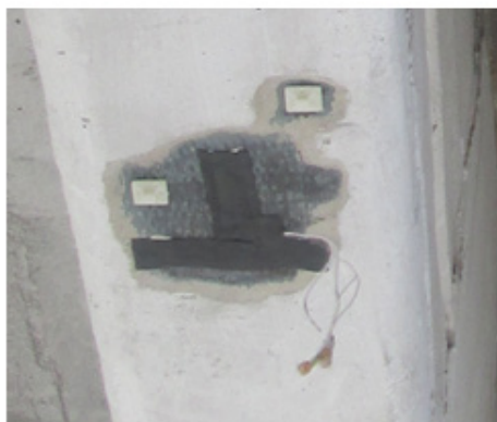
Рис. 2. Тензорезисторы FLM-60–11 с защитным покрытием от климатических воздействий на нижних гранях ребер плит.
