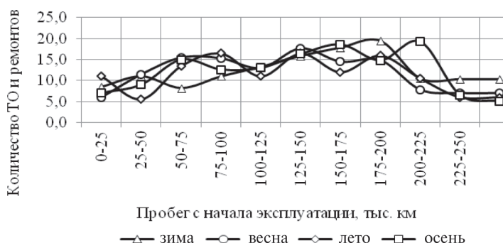
Рис. 2. Зависимость числа ТО и ремонтов автосамосвала БелАЗ-7547 за сезон от пробега с начала эксплуатации.
